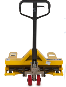
Maneral de operación con manija de 3 posiciones.
