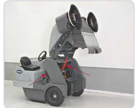
Para óptima seguridad, el brazo de seguridad de la tolva puede bloquearse sin salir del asiento del operador. Además, el sistema de barrido cesa automáticamente cuando el movimiento de la máquina se detiene.
