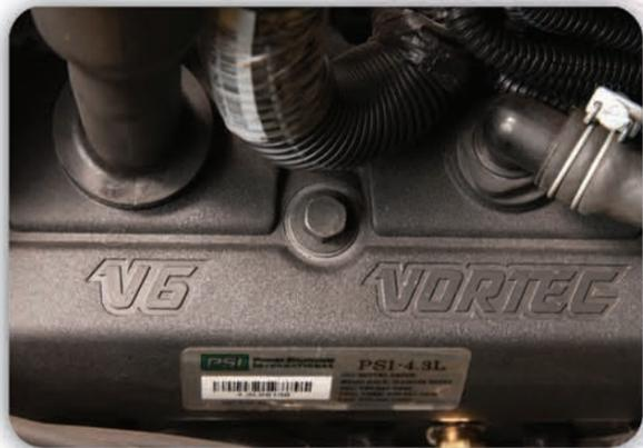
Para proporcionar energía y una mayor eficiencia de combustible tanto en Gasolina como en Gas L.P. La serie VT viene equipada con el poderoso motor General Motors® Vortec 4.3L de 6 cilindros en V con sistema de inyección electrónica.
