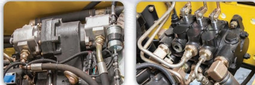
La inigualable combinación de poder de sus dos bombas hidráulicas de engranes acopladas directamente al motor proporcionan un caudal inigualable con un gran poder hidráulico. El resultado: Velocidad de elevación más rápida que permite que sus operaciones sean más fluidas.
