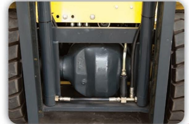
El diseño del eje motriz flotante tipo Heavy Duty permite que la carcasa del diferencial, no sus flechas, cargue el peso de la carga, mejorando la confiabilidad y dando una vida útil más larga de su montacargas.
