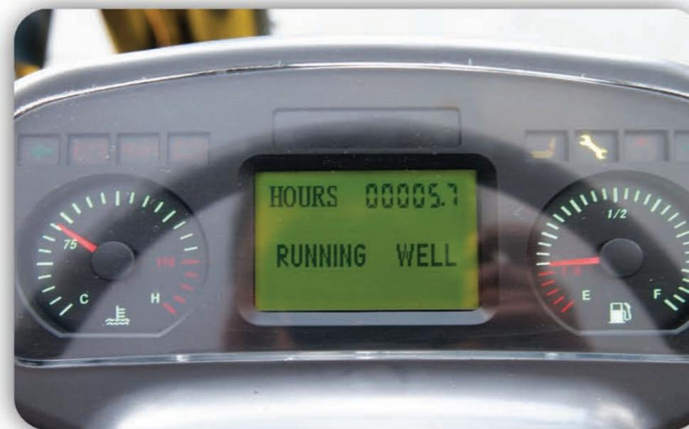
Con el display digital combinado con indicadores analógicos, el operador podrá supervisar continuamente el desempeño de todos los sistemas. La temperatura del motor se puede verificar constantemente en el manómetro tipo reloj para que inmediatamente se tomen las medidas correctivas. Horómetro, presión de aceite del motor, freno de estacionamiento aplicado e indicador de bajo combustible son ejemplos de los indicadores y luces de advertencia.
