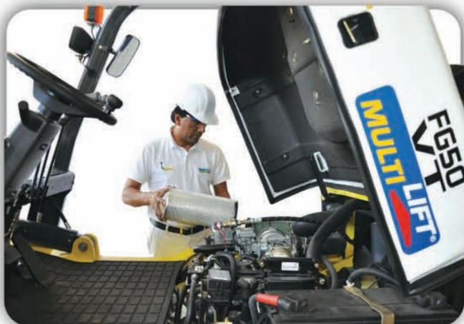
Con mínimo esfuerzo, gracias a su sistema de apertura asistida, la plataforma del asiento se levanta para tener acceso al motor por ambos lados y además, los paneles de pisos desmontables inferiores se pueden remover fácilmente para tener acceso a los sistemas hidráulicos y componentes de la transmisión.
