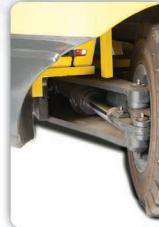
El eje direccional de uso rudo utiliza un cilindro hidráulico transversal con terminales fijas que eliminan la necesidad de ajustes. Cuenta con un número conveniente de graseras para mantener siempre lubricadas las piezas de desgaste.
