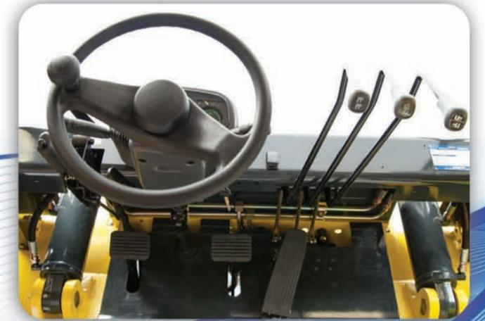
Palancas ergonómicas para sistema de elevación, inclinación y desplazador lateral. Pedales anti derrapantes de freno de servicio y pedal de acercamiento lento que incrementan la exactitud de las maniobras y el rendimiento del montacargas.
